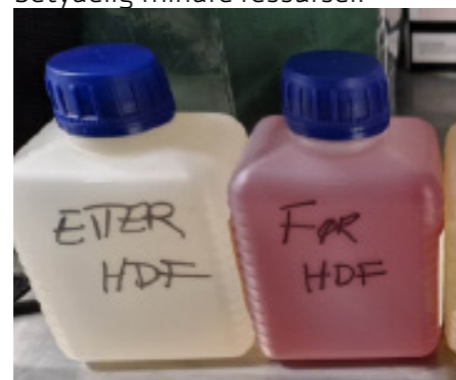
Figur 4: Avløpsvann før og etter HDF
